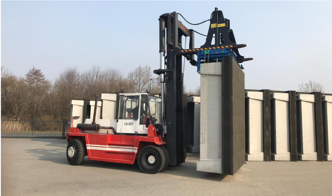
Visual 8.10-5: Heftruck met liftingtool voor Ecovat prefab elementen.
