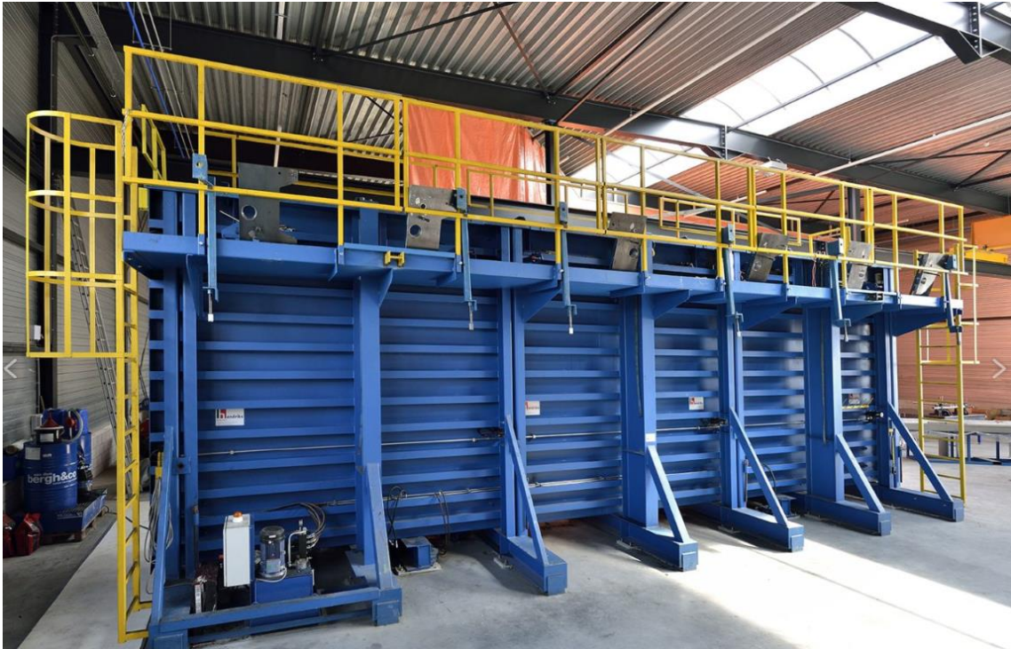
Foto 8.1.-1: Stalen bekisting Ecovat Werk B.V. in Oss.
